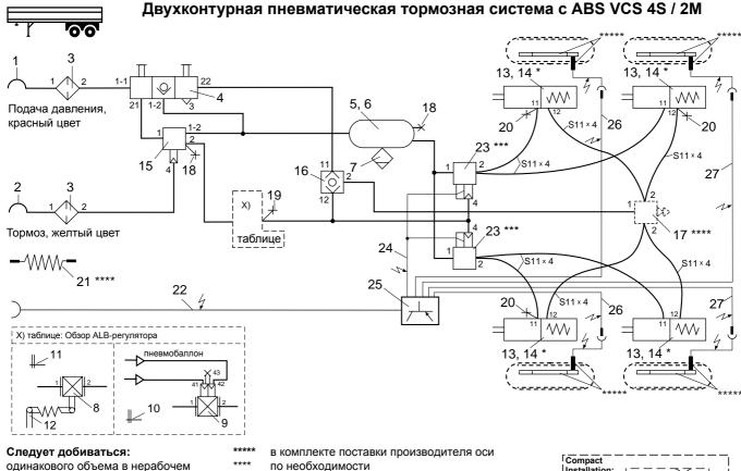
одинакового объема в нерабочем состоянии положении всех тормозных цилиндров, и соответствующих им тормозных шлангов, идущих от ускорительного клапана ABS
