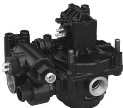
Ускорительный клапан системы EBS используется в электропневматической системе в качестве привода для изменения тормозного давления на передней оси прицепов с дышлом либо на третьей оси полуприцепов.
