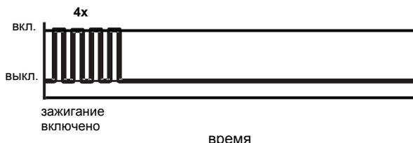
Если провод индикатора остается перетёртым на протяжении более четырех минут, на вход для сигнала о степени износа подается напряжение в 4,5V срабатывает второй сигнальный уровень. Вслед за включением зажигания предупреждающий световой сигнал системы ABS вспыхивает 4 раза подряд (4 цикла, всего 16 вспышек).
