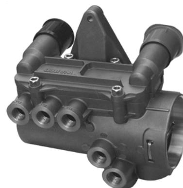
Клапан аварийного затормаживания выполняет функцию аварийного торможения в случае повреждения подводящей пневматической линии, а также способен заменять воздухораспределитель.
