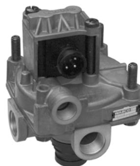
Ускорительный клапан системы ABS, сходный с аналогичным устройством стандартных тормозных систем, и сдвоенный обратный клапан используются в электропневматической системе в качестве привода для изменения тормозного давления на управляемые оси полуприцепа. Управление электрическими цепями и слежение осуществляются через модулятор прицепа.
