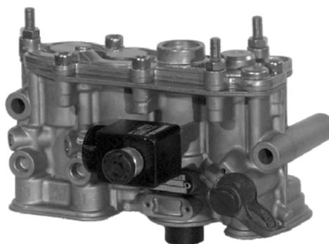
Клапан подъемной оси, сходный с аналогичным устройством стандартных тормозных систем, обычно используется для автоматического управления одним либо двумя подъемными осями посредством системы EBS прицепа в зависимости от текущей нагрузки на ось. Управление электрическими цепями и слежение осуществляются модулятором прицепа.
