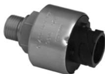
Внешний датчик тормозного давления, как правило, подключается к разъему "IN/OUT 2" модулятора прицепа (любой модификации, кроме 480 002 010 0) с целью улучшения синхронизационных характеристик. Данный датчик измеряет контрольное давление тормозной магистрали и передает полученное значение в модулятор прицепа.
