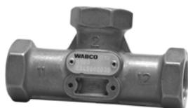
Сдвоенный запорный клапан применяется в транспортных средствах со схемой управления 2S/2M + Select Low с целью обеспечения поочередного осевого торможения (напр., начиная с управляемой оси). Входными значениями давления являются выходные значения,
